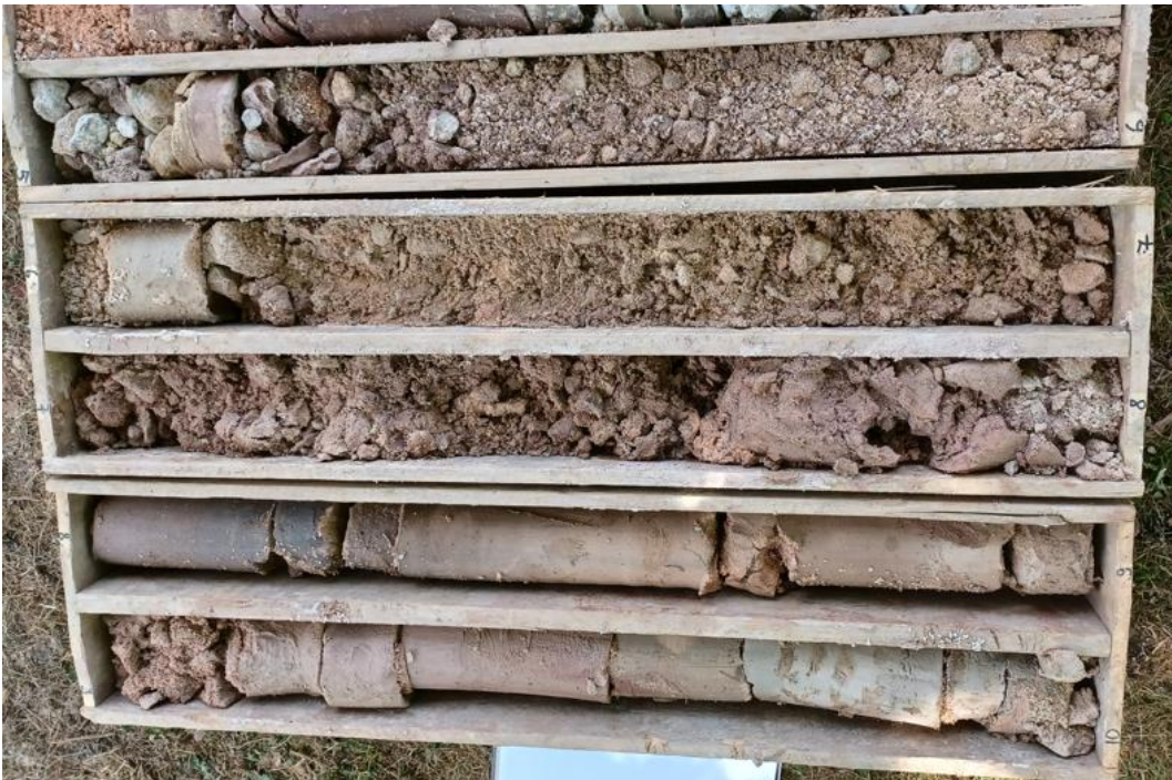
Foto Nr. 11: Kernbohrung KB 194 (5,0 m - 10,0 m)
