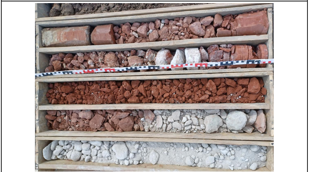
Foto Nr. 4: Kernbohrung KB 140 (4,0 m - 9,0 m)
