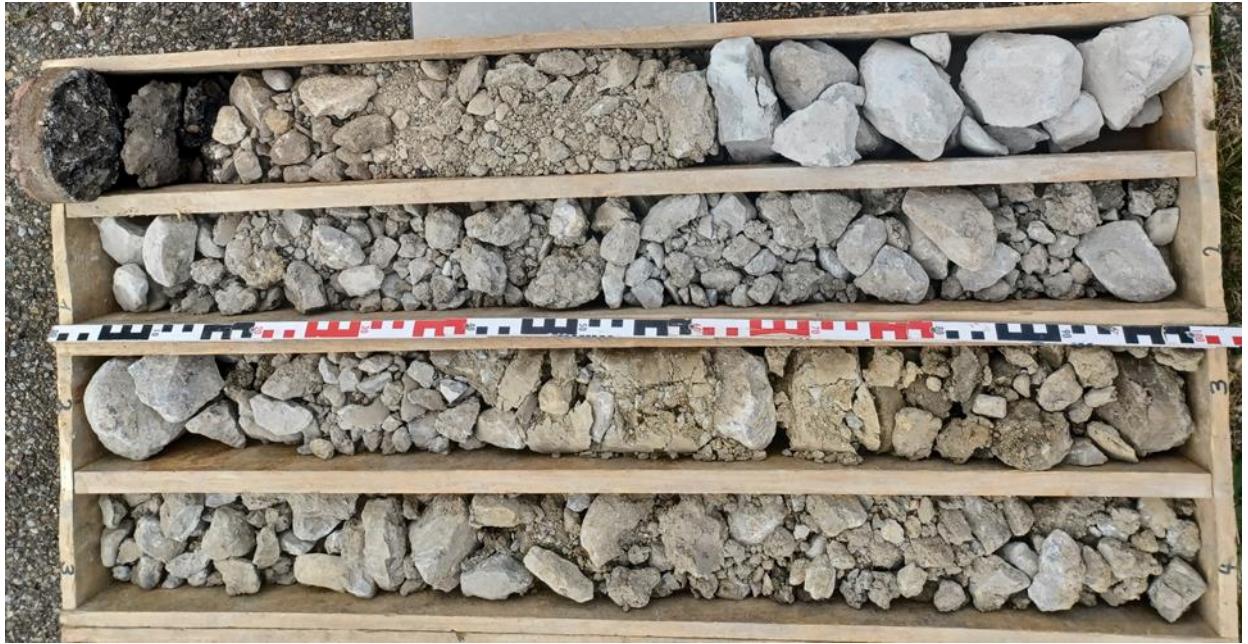
Foto Nr. 23: Kernbohrung KB 97 (0,0 m - 4,0 m)
