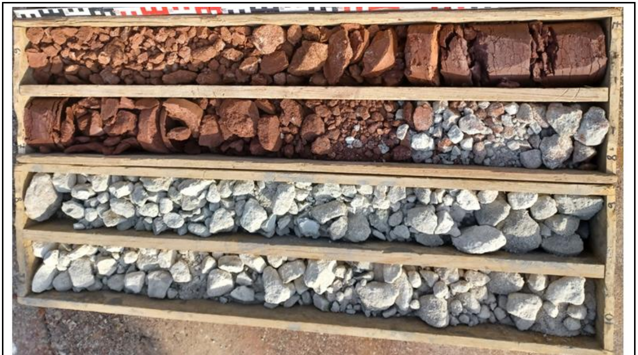
Foto Nr. 19: Kernbohrung KB 84 (6,0 m - 10,0 m)
