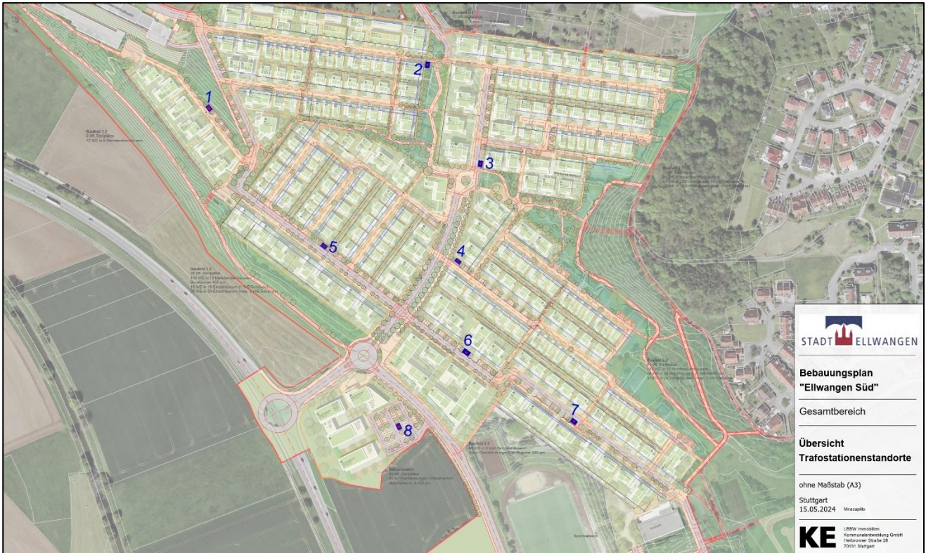
Abbildung 28: Übersicht Trafostationsstandorte (KE)
